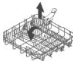
Z podnoszonymi podporami
