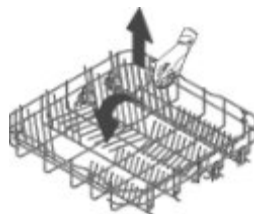
Z podnoszonymi podporami
